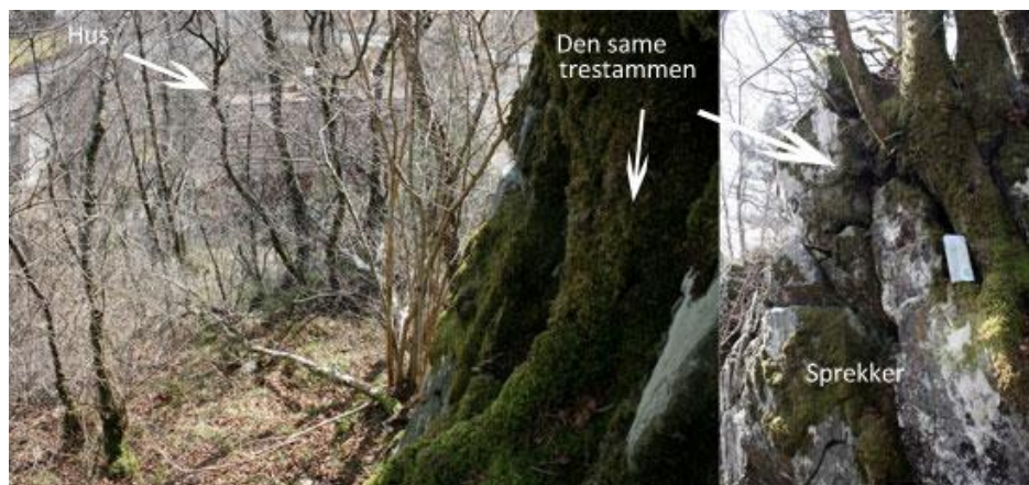
Figur 39. Biletet til venstre viser avstanden frå fjellskrenten til bustadhuset. Vegetasjonen er hovudsakleg gras og unge tre. Biletet til høgre viser at fjellskrenten har mange sprekker og det veks tre i fleire av sprekkene. Eit samanbretta kart som skala viser at røtene er til dels store.
