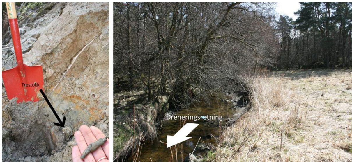
Figur 22. Døsjaelva passerar den flate Skeisbotnen som antyda på høgre biletet. Graving i elvebreidda viser organisk innhald og mykje fint materiale, som leire. Snittet vart laga i høgre elvebreidd like bak treet midt i biletet.
