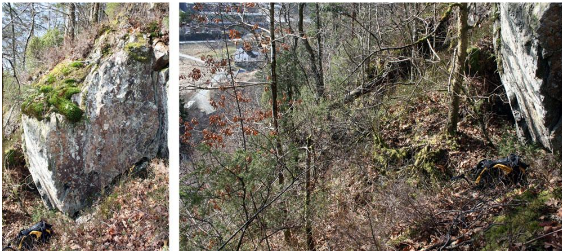
Figur 36. Bildet til venstre viser ei om lag 5 m 3 stor blokk med opne sprekker rundt. Ein ryggsekk ligg på bakken for målestokk. Biletet til høgre viser same blokka, samt skråninga under blokka som går ned mot bustadhuset. Skråninga er dekkja av kratt og busker, som bildet viser.
