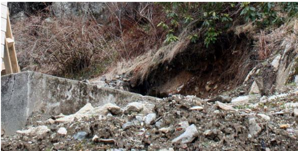
Figur 56. Snitt i skråninga under fjellskrenten viser kanta blokker og steinar, samt jord.
