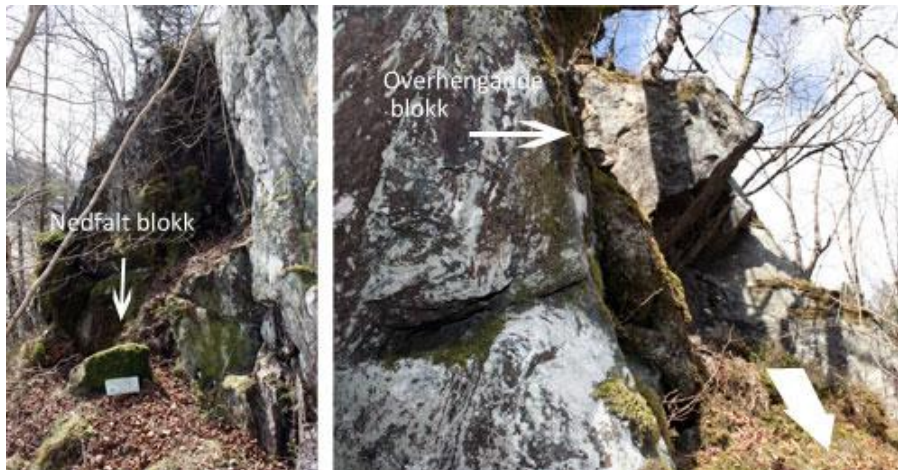
Figur 37. Biletet til venstre viser at like nedanfor fjellskrenten har ei blokk falt ned, men ikkje trilla ned skråninga mot venstre (samanbretta kart som skala). I fjellskrenten er også fleire opne sprekker synlig. Biletet til høgre viser at i same fjellskrenten er det framleis overhengande blokker. Den breie pila indikerar skråningsretninga.
