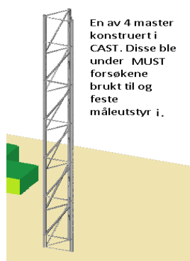
Figur 14 viser 1 av de fire 6 meter mastene
