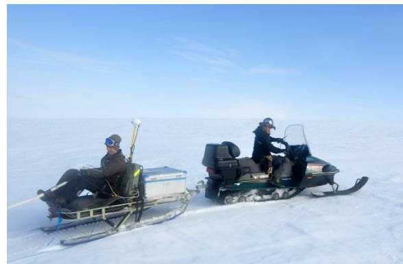
Figur 19: Montering av georadar utstyr på snøscooter. Foto: Åsmund Bakke.
