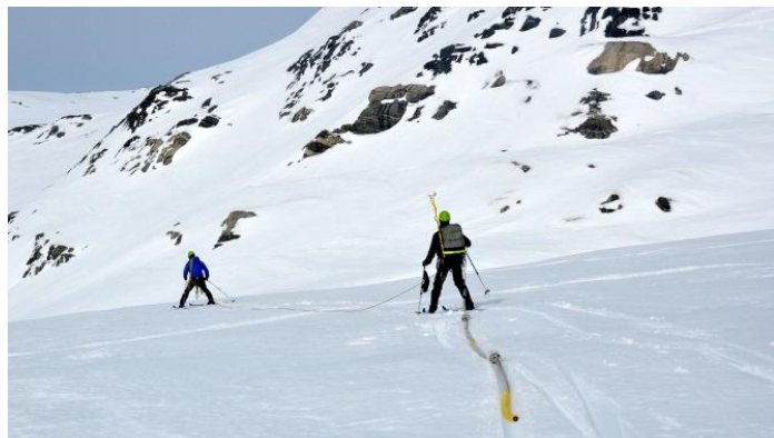
Figur 10: Bilde viser en Malå RAMAC antenne som er praktisk i ulendt terreng. Denne er også veldig mobil da utstyret kan pakkes i en sekk og bæres på ryggen. Foto: Jostein Bakke.
