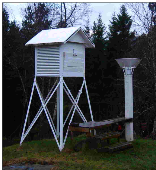
Tradisjonell norsk værstasjon med måling av temperatur to meter over bakken med instrument skjermet for stråling i hvit hytte med god luftning. Nedbørmåler til høyre. Glomset værstasjon i Skodje (Møre og Romsdal). http://sivle.mother.no
