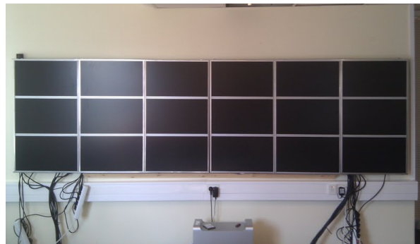
Figur 2: viser hvordan MIMIR er satt opp med 18 skjermer som alle er 24 tommer, med en aluminiumsramme som holder skjermene sammen.
