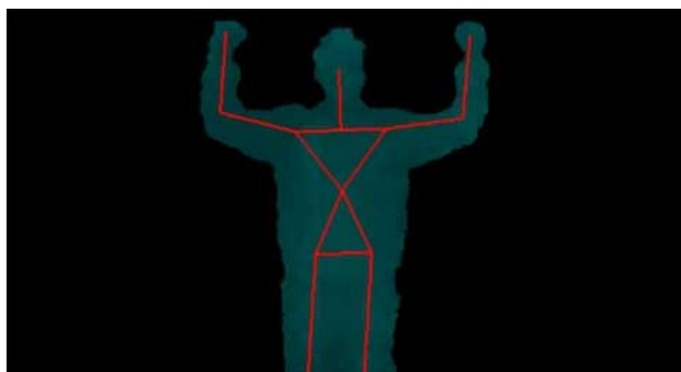
Figur 10: viser posituren for å kalibrere FAAST-programvaren. Den blå skyggen er det infrarøde bildet av brukeren, den røde strekfiguren er skjelettet som vises etter en vellykket kalibrering.
